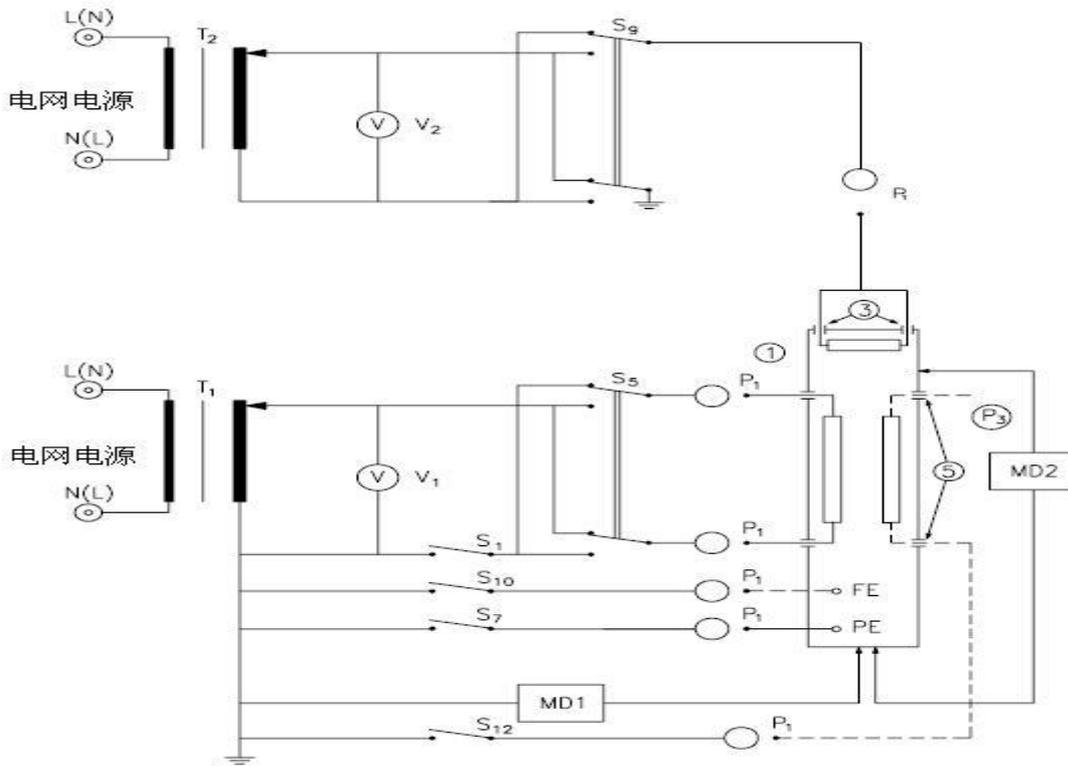
图 18 外壳漏电的测量设备
