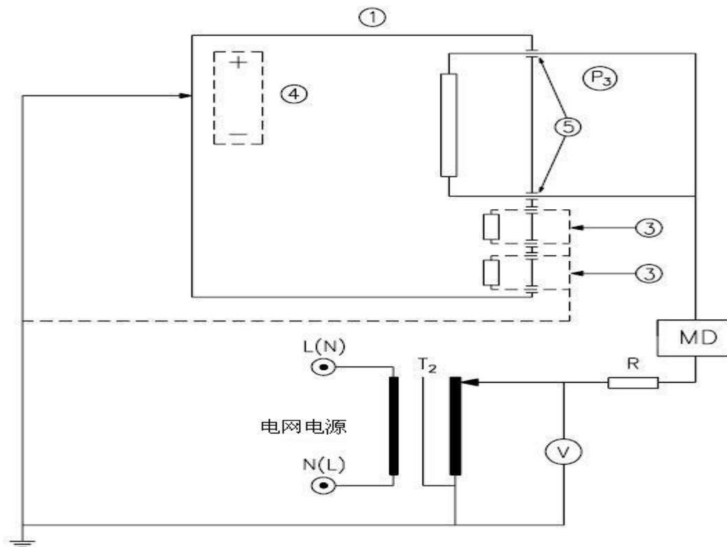
图 24 内部电源供电设备从 F 型应用部分至外壳的患者漏电流的测量电路
