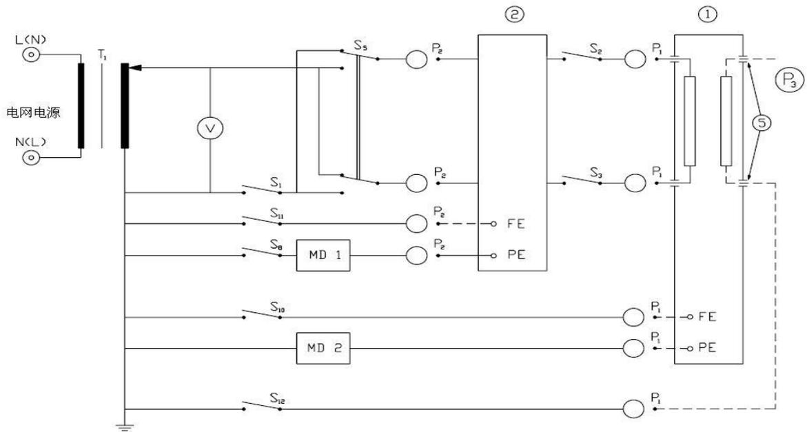
图 17 使用规定的 I 类单相电源，具有或没有应用部分的设备对地漏电的测量电路
