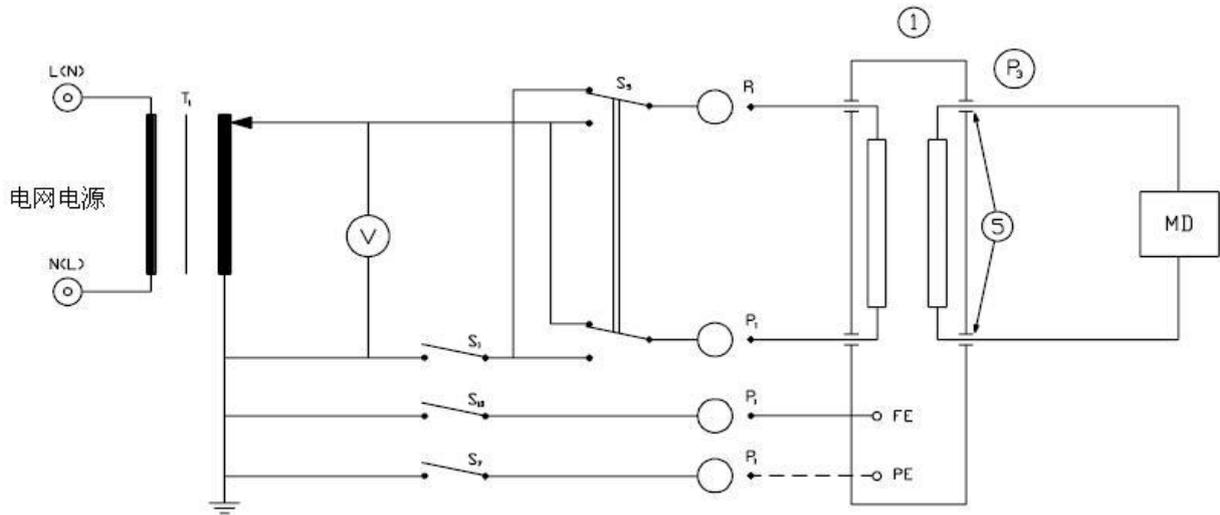
图 26 患者辅助电流的测量电路
